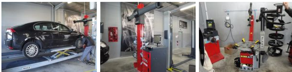
Espace Atelier et technicité de pointe (ici ponts, parallélisme 3 D, poste de montage des pneus)
